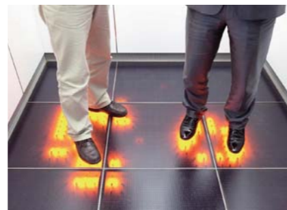
현대아산타워에 설치된 LED 영역표시 바닥센서 기능은 디자인 공모전에서 입상한 수상작에서 아이디어를 얻어 제작했다.
