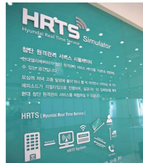
HRTS는 인터넷을 통해 전국에 있는 엘리베이터의 운행상태를 365일 24시간 실시간으로 감시하는 시스템으로 원격으로 안전점검과 고장처리까지도 수행한다.
